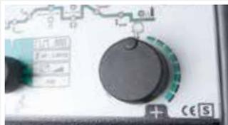
Stufenlose Strom- und Gaseinstellungen mit Ein-Knopf-Bedienung
