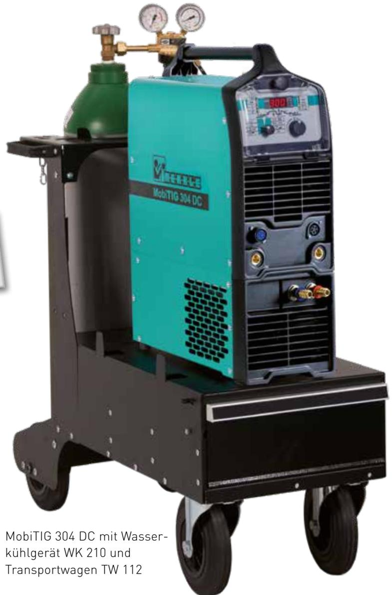
MobiTIG 304 DC mit Wasserkühlgerät WK 210 und Transportwagen TW 112
